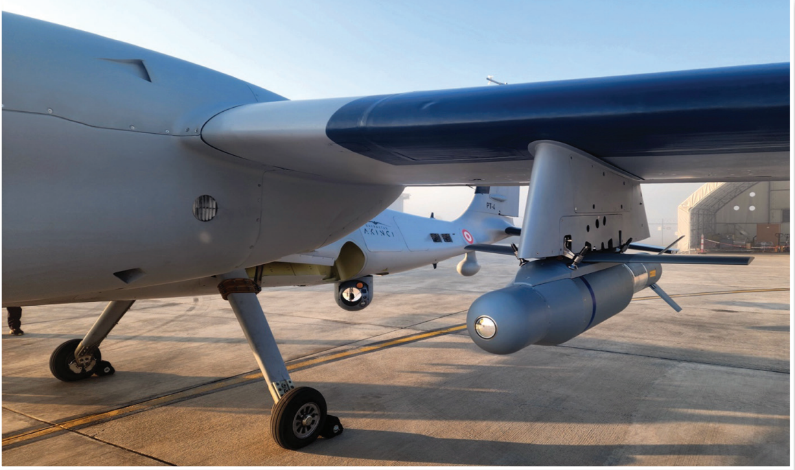
Fotoğraf 4: BAYKAR Akıncı SİHA'sına Entegre Edilen ASELSAN Tarafından Geliştirilmiş ASELFIR-500
